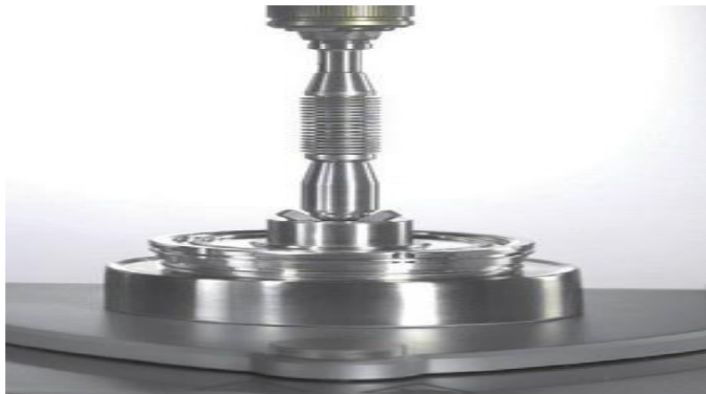
Şekil 2: Paralel plaka ve konik-plaka geometrileri ile kullanılabilen Peltier plakalı sıcaklık kontrolüne sahip HAAKE MARS iQ Reometre
