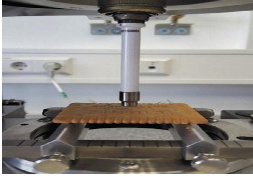
Şekil 3: 8 mm plaka rotoru ile HAAKE MARS iQ Reometre kullanılarak bükülme ve kırılma testlerinin gerçekleştirilmesi için 3 nokta bükme aparatı.
