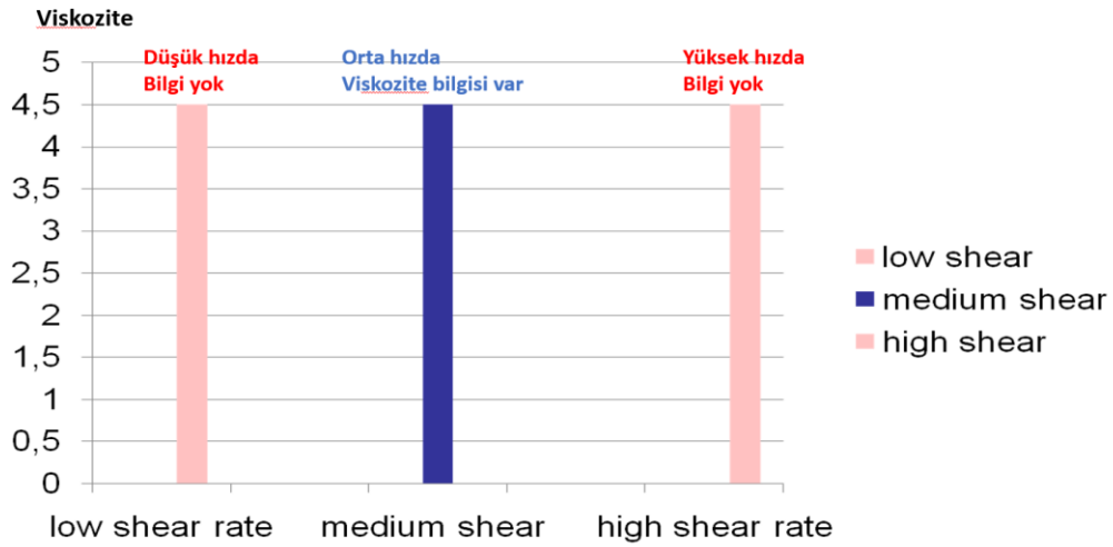
Şekil 5. Tek kayma hızında elde edilen viskozite bilgisi
